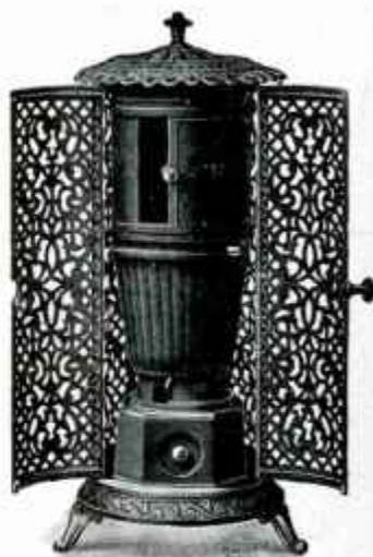
Les calorifères à feu continu N<sup>os</sup> 2129, 2130, 131, 132 et 132<sup>B</sup> sont construits avec deux foyers en fonte : l'un pour l'usage de la houille, de l'antracite, du coke ou des boulets, et l'autre spécial pour la tourbe. Le foyer à houille est muni d'une grille à mouvement de va-et-vient. Chacun des foyers est muni à la partie supérieure d'un tampon de grand diamètre. Les pieds sont mobiles.
