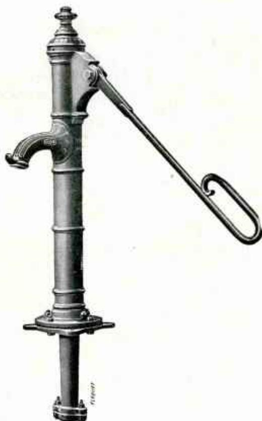
Dans la nouvelle pompe aspirante genre colonne (dite du Midi) N° 102, le corps de pompe et la tête sont en fonte, le balancier est en fer forgé, le piston est en fonte avec garniture en caoutchouc ; sa partie supérieure est terminée par un étrier percé d'un trou, dans lequel vient se visser la tige du piston.
