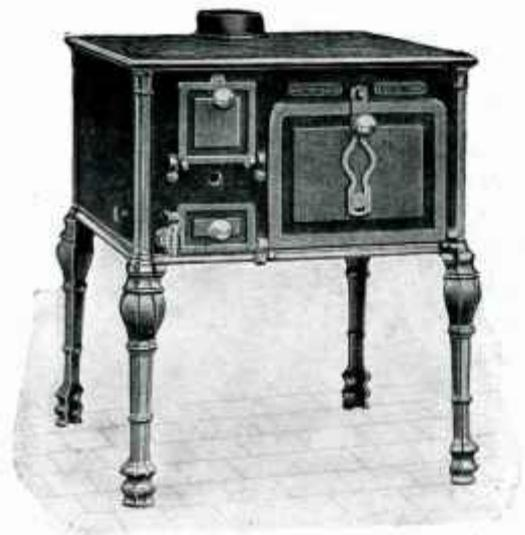
Les cuisinières N<sup>os</sup> 2351<sup>B</sup> à 2356<sup>B</sup> ont un foyer rond à houille placé à gauche avec grille de devant et porte au foyer. Le four est chauffé par le rayonnement du foyer dans les N<sup>os</sup> 2351<sup>B</sup> à 2354<sup>B</sup> et par la circulation de la flamme dans les N<sup>os</sup> 2355<sup>B</sup> et 2356<sup>B</sup>. La buse est mobile et peut être placée dessus ou derrière.
