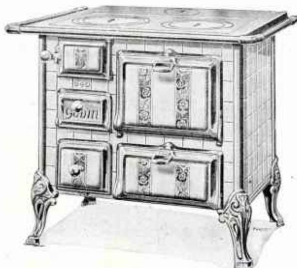
Les nouvelles cuisinières en fonte sans chaudière N<sup>os</sup> 2939, 940 et 941, possèdent un foyer ovale spécial pour la houille. Le four est chauffé par la circulation de la flamme. Un tampon de grande dimension est disposé sur le fond du four pour faciliter le nettoyage du conduit de fumée. Le quadrillage de la devanture et des côtés est en relief. Les portes de four et d'étuve sont munies d'une poignée horizontale. La porte de four est équilibrée par un ressort.
