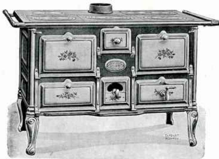
Les cuisinières N<sup>os</sup> 891, 892 et 893 sans chaudière et N<sup>os</sup> 894, 895 et 896 avec chaudière, possèdent un foyer rond à houille et un dessus à taques mobiles. La buse est mobile et peut être placée dessus ou derrière. Les fours sont chauffés par le rayonnement du foyer dans les cuisinières N<sup>os</sup> 891 et 894 et par la circulation des flammes sur le côté des fours dans les cuisinières N<sup>os</sup> 892, 893 et 895, 896.
