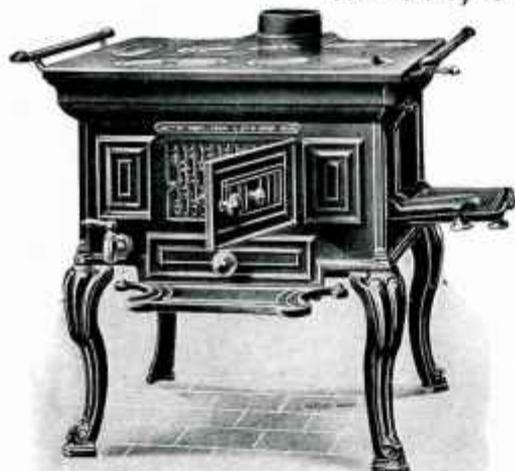
Les cuisinières N<sup>os</sup> 411, 412 et 413 ont un foyer spécial pour l'usage du bois, avec porte de chargement sur le côté et grille verticale en avant. La buse est mobile et peut être placée dessus ou derrière.
