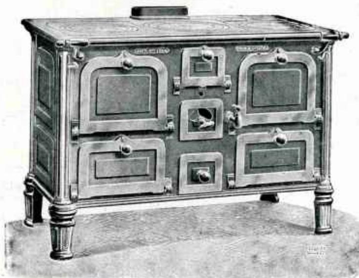
Les cuisinières N<sup>os</sup> 364<sup>a</sup> à 366 avec chaudière et N<sup>os</sup> 364<sup>bs</sup> à 366<sup>s</sup> sans chaudière ont un foyer rond à houille. Les fours sont chauffés ensemble ou séparément par la circulation de la flamme. La buse est mobile et peut être placée dessus ou derrière.
