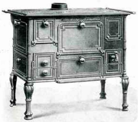
Les cuisinières N<sup>os</sup> 1240, 1241, 1242 et 1243 ont un foyer à houille rectangulaire et rétrécissable. Le four est chauffé par la circulation des flammes. La buse est mobile et peut être placée dessus ou derrière.
