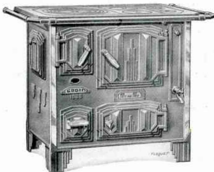
Les nouvelles cuisinières N<sup>os</sup> 1080, 1081 et 1082 entièrement en fonte possèdent un foyer ovale à houille. Le tirage direct ou à circulation de flammes est obtenu par la manœuvre d'une targette commandée par un bouton placé sur la devanture. Des tampons de grandes dimensions, disposés sur le fond du four et sur le dessus d'étuve, facilitent le nettoyage du conduit de fumée.
