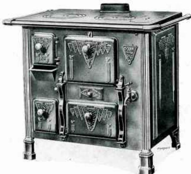
Les nouveaux fourneaux 100 à 104 et 100<sup>D</sup> à 104<sup>D</sup> ont la devanture en fonte. Les portes, également en fonte, sont bombées et ornées style moderne. Le four est chauffé par la circulation de la flamme. Le foyer, toujours en fonte, est mixte et rétrécissable. La buse peut être placée à volonté dessus, derrière en haut, ou à mi-hauteur du fourneau.
