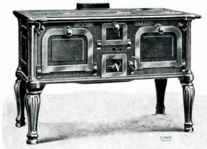
Les cuisinières N<sup>os</sup> 315, 316, 317 et 318 ont un foyer à houille. Les fours sont chauffés ensemble ou séparément par la circulation de la flamme. La buse est mobile et peut être placée dessus ou derrière.
