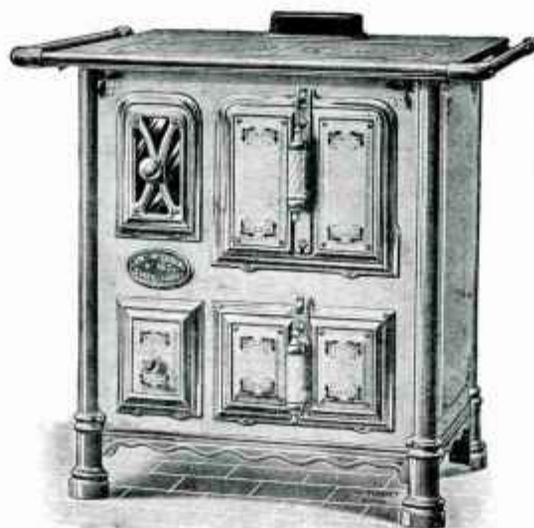
Les cuisinières en tôle et fonte N<sup>os</sup> 955, 956 avec chaudière, N<sup>os</sup> 965, 966 sans chaudière ont un foyer ovale permettant, par simple retournement bout pour bout de la grille, de diminuer la capacité du foyer. La devanture et les côtés sont assemblés au moyen de vis. Le four est chauffé par la circulation de la flamme. Toutes les pièces exposées au feu (dessus de four, côté de four, etc.) sont en fonte.
