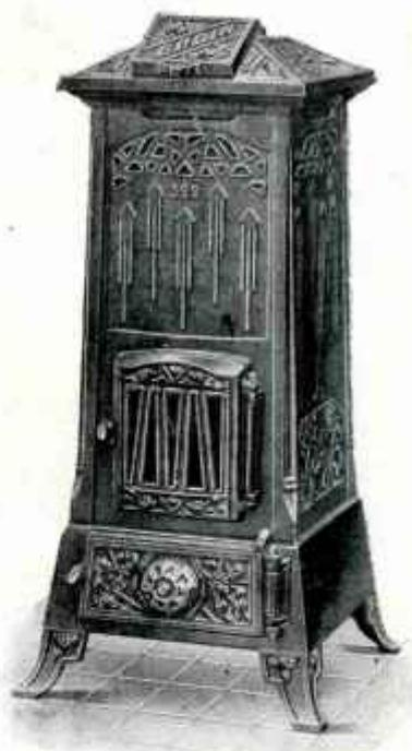
Les nouveaux calorifères hygiéniques N<sup>os</sup> 390 et 392 possèdent un foyer cylindrique en tôle revêtu intérieurement d'une épaisse garniture réfractaire. La grille est pivotante et manœuvrable de l'extérieur. Le réglage s'opère au moyen d'une valve à vis placée sur la porte de cendrier. La buse peut être placée à volonté dessus ou derrière en haut. Dans le calorifère N<sup>o</sup> 390, la buse peut également être placée derrière en bas.
