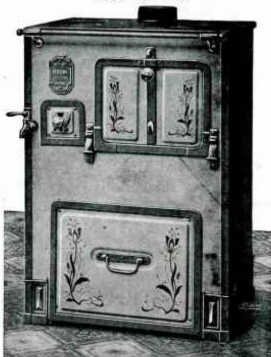
Dans ces fourneaux le foyer est rectangulaire et d'une seule pièce. Le four est chauffé directement par le rayonnement du foyer. La buse mobile peut être placée à volonté dessus ou derrière. La barre de devant, les supports et les boutons sont nickelés. Les colonnes d'angle, les encadrements des portes, les clenches et crapaudines sont polis fin. Des plaques de protection en fonte garantissent le côté et la devanture à l'endroit du foyer.
