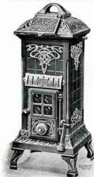
Ces calorifères ont le foyer garni intérieurement de briques réfractaires. La grille est pivotante et manœuvrable de l'extérieur. Le réglage s'opère : 1<sup>o</sup> par la valve de la porte de cendrier ; 2<sup>o</sup> par la valve de la buse commandée par une poignée placée sur le côté droit. La buse est mobile et peut être placée à volonté dessus ou derrière en haut ; sauf quand les appareils sont demandés à buse coude en bas.
