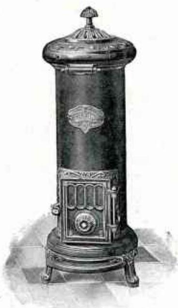
Les nouveaux calorifères hygiéniques à feu continu N° 141, 142 et 143 ont le fût en tôle garni intérieurement de briques réfractaires ; la grille est pivotante et manœuvrable de l'extérieur. La partie supérieure de la tête est protégée par des doublures intérieures en fonte.
