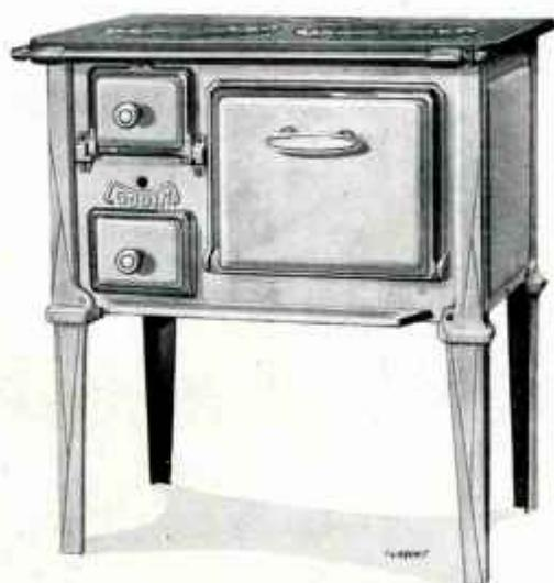
Les nouvelles cuisinières en fonte et tôle N°s 759 et 760 sont munies d'un foyer ovale à houille ; le four est chauffé par la circulation des flammes, la devanture est en fonte, les côtés sont en tôle emboutie et à double paroi. La porte de four est équilibrée par un ressort.
